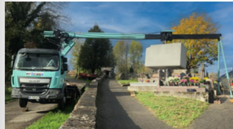
Pose 4 tonnes jusqu'à 10 mètres, selon configuration.
