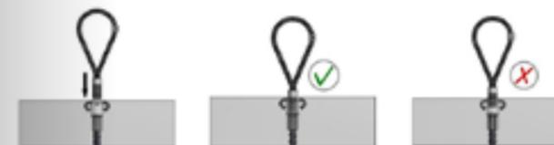
Assurez-vous que le filetage est complètement au fond de la douille de soulèvement avant le levage. Il est possible de le dévisser d'un tour pour être sûr que le câble soit correctement aligné pour le levage. **Aucun écart entre l'élément béton et le châssis du système de levage n'est autorisé : le filetage doit être complètement vissé dans la douille.**
