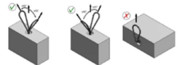
Les élingues doivent être utilisées uniquement pour des tractions obliques dont l'angle est compris entre 0° et 45° par rapport à l'axe de la douille. Les boucles de levage à visser ne conviennent pas pour le retournement et le basculement.
